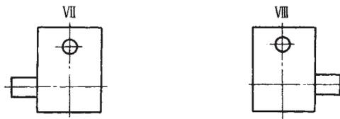
图 4.5 KWO 型 VII、VIII 蜗杆减速器
